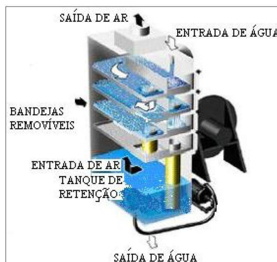
Figura 11: Esquematisação de um Low Profile Air Strippers
